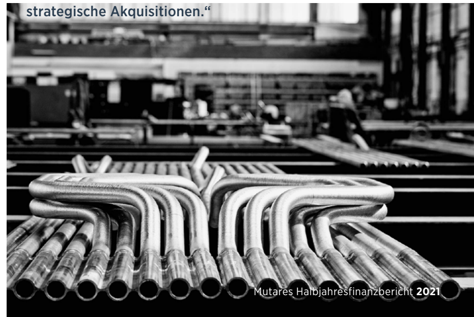
Rohrausbiegungen als Teil eines Austausch von Kesseldruckteilen
